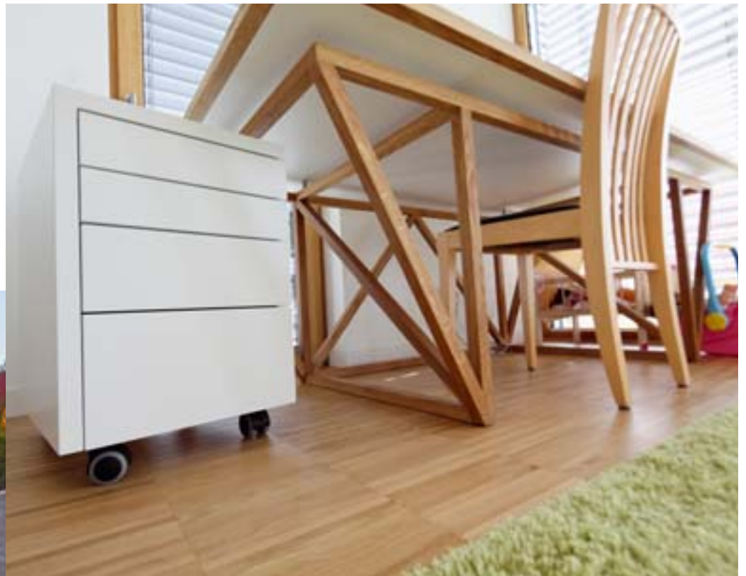
Rollcontainer mit seitlich eingefräster Griffnut. Tischgestell in Eiche mit gedübelten Verbindungen
