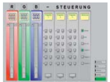
Die Steuerung der RGB-Beleuchtung erfolgt über ein Visualisierungsprogramm am PC
